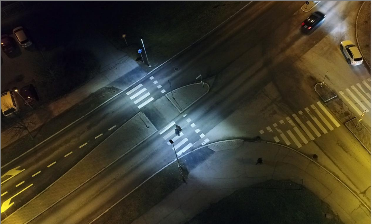
Kuva 8. Tuomarilantien älykäs suojatievalaistus toiminnassa (vasemmanpuoleinen suojatie).
