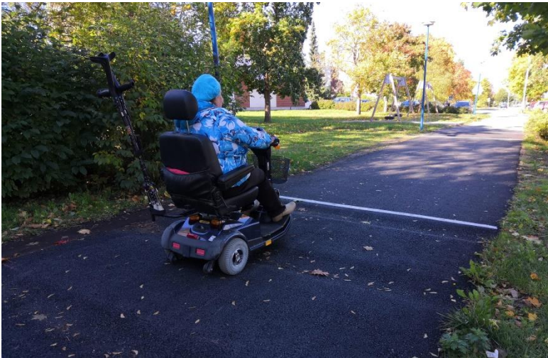
Kuva: Hidasteiden testausta sähkömopolla
