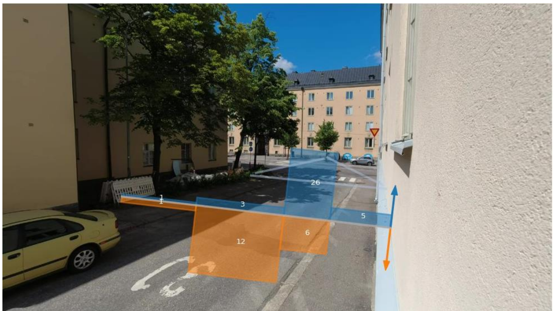
Kuva 11 Pyöräliikenteen sijoittuminen ajosuunnittain kadun poikkileikkauksessa (ennen-tilanne).
