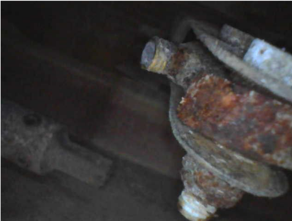
Kuva 1 Ruostunut ja katkennut työntötangon pää siiven sisällä
