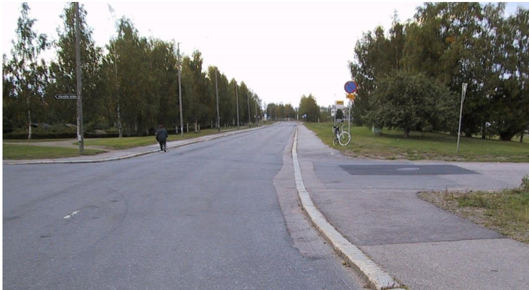
Kuva 47. Oikealta tulevien väistämismellollisuutta on vahvistettu liikennemerkin lisäksi kiveyksellä, jotta risteävän, suoran tien kulkijat eivät mieltäisi katuaan etuajo-oikeutetuksi.
